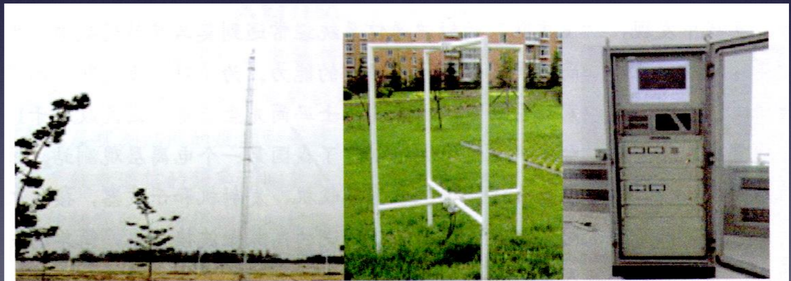
▲ TYC-1型数字式垂直探测仪的发射天线、接收天线和主机柜
